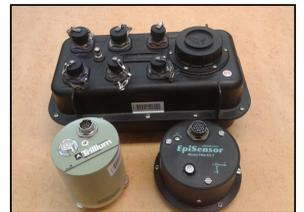
Figura 3. Grabadora REFTEK130, sismómetro Trillium Compact, acelerómetro Episensor.
