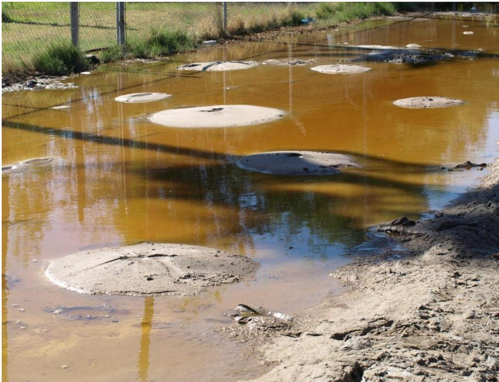
En esta fotografía se observa los volcanes de arena y agua que se forman por el proceso de licuefacción del subsuelo somero (de 2-8 m de profundidad). En la siguiente fotografía se puede observar como el lodo cubre gran parte del patio de una iglesia y se acumuló hasta una altura de 30-40 cm.
