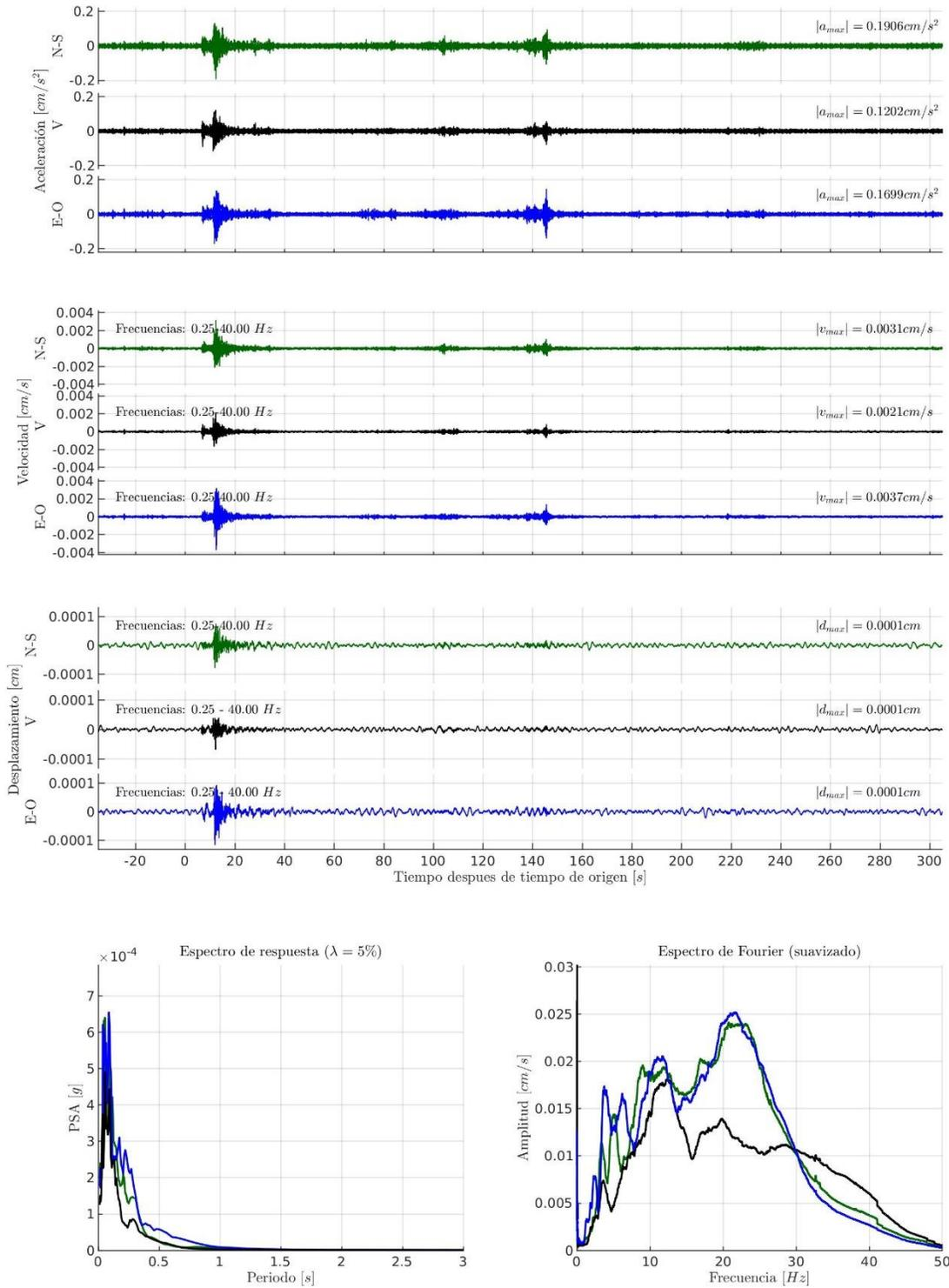
Figura 4. Gráficas del volumen 1, 2 y 3 del procesamiento de la Red Acelerométrica del Noroeste de México.
