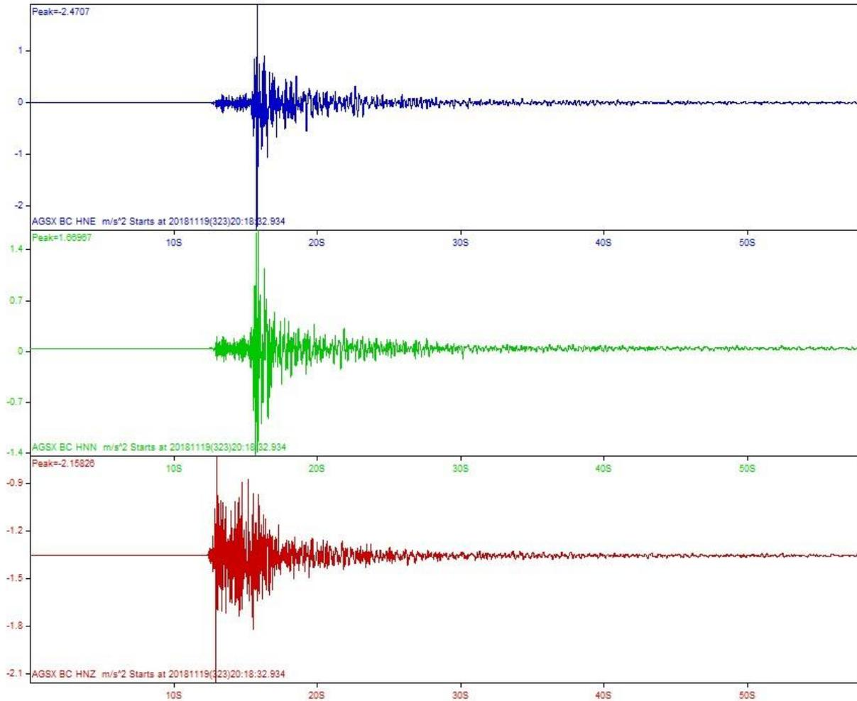
Figura 6. Aceleraciones registradas en estación Aguas Calientes, durante el sismo 19 de noviembre de 2018 de  $M_L 4.9$ .
